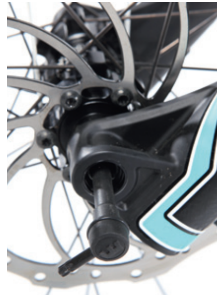
De steekas demonteer je met een Torx-sleutel, die in de vooras zit.
